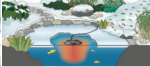
Schematische Darstellung: IceFree Thermo Funktionsprinzip
