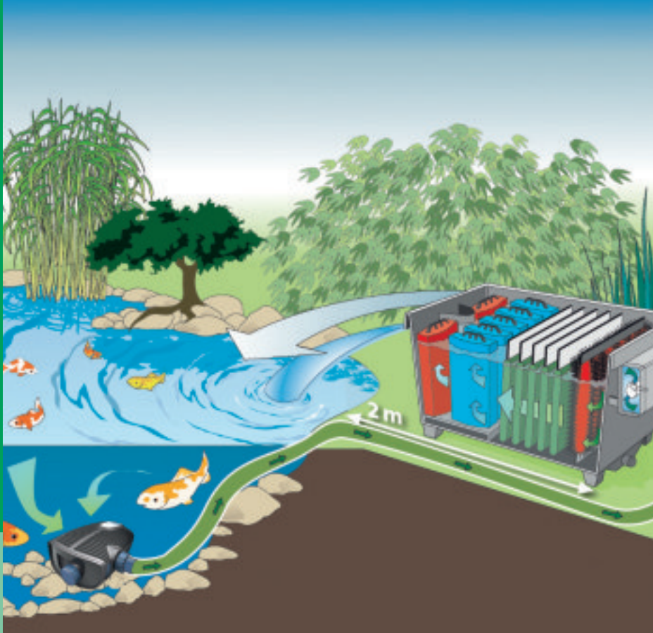
Schematische Darstellung: BioTec 30 in Funktion mit einer Filter- und Bachlaufpumpe und einem Bitron C
