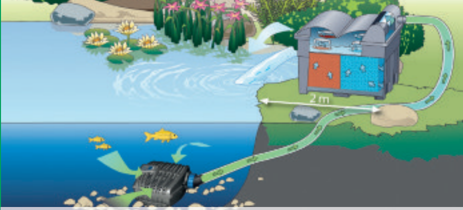
Schematische Darstellung: BioSmart UVC 16000 in Kombination mit Filter- und Bachlaufpumpe AquaMax Eco Classic
