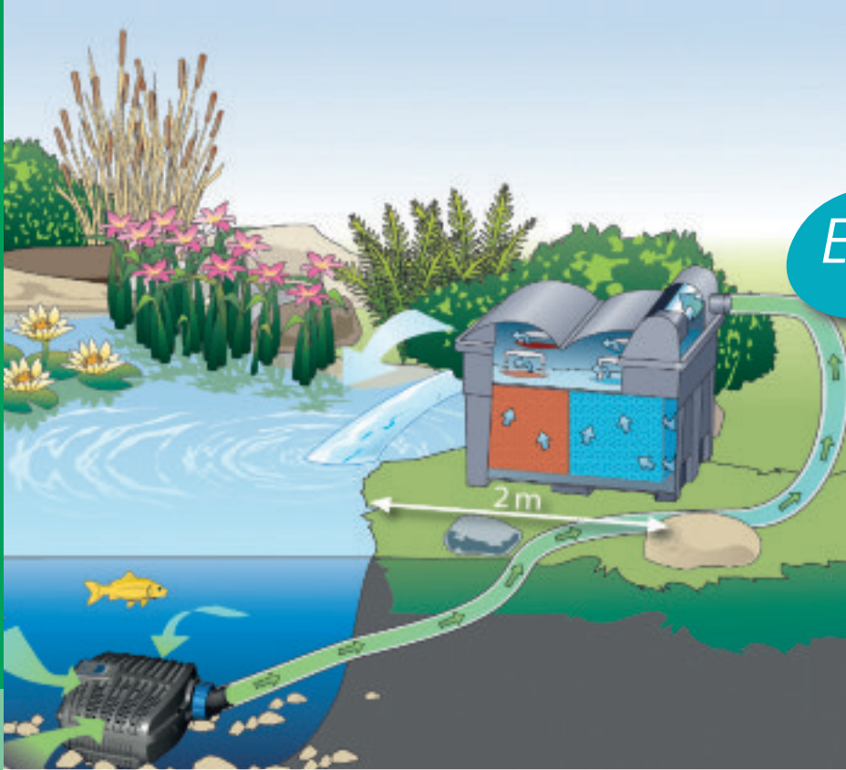
Schematische Darstellung: BioSmart Set Komponenten in Funktion
